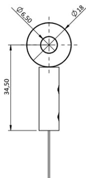
**Accroche du câble de mesure par une tige filetée M4 :**
