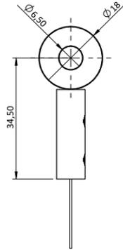
**Accroche du câble de mesure par émerillon :**
