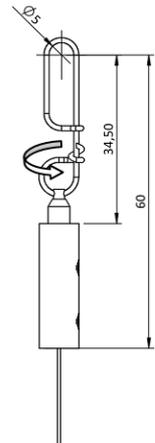
**Accroche du câble de mesure par une tige filetée M4 :**
